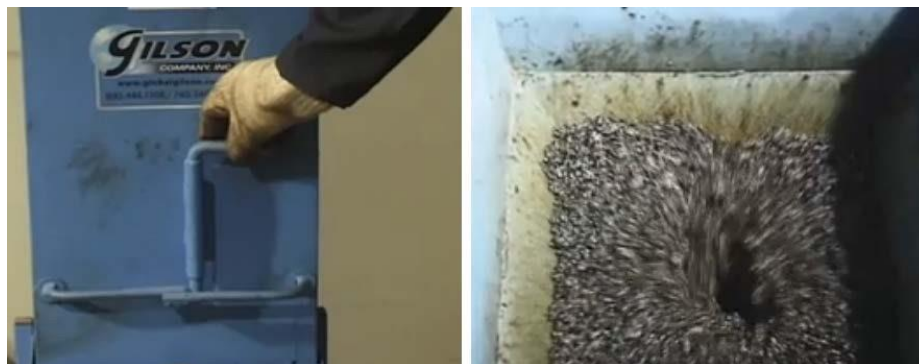
Figura 776 - 4. Accionamiento de la manija para permitir la caída de la mezcla
